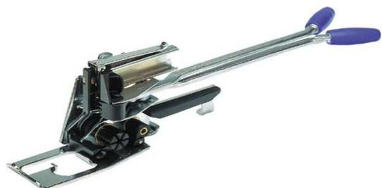
Weiterentwicklung des Combi-Spanners für größere und rationellere Verpackungskapazitäten. Durch das eingebaute Hülsenmagazin werden die Verschlusshülsen beim Spann- und Verschlussvorgang automatisch auf das Band aufgelegt.
