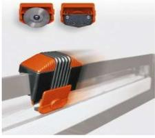
Der ergonomisch gestaltete Schneidschlitten schneidet unfallsicher in beide Bewegungsrichtungen. Die Messerkassette lässt sich mit einem Handgriff auswechseln. Kassette mit Rundmesser für Papier, Wellpappe etc., Kassette mit Klinge für alle Weichfolien. Eine Klemm-Mechanik sorgt für bequemes Einlegen des Materials und sicheres Nachfassen nach jedem Schnitt.
