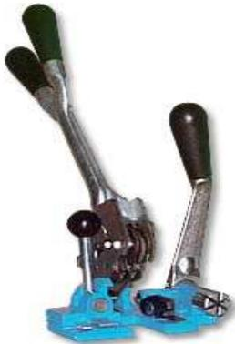
Praktisches, universelles und wirtschaftliches Umreifungsgerät in einteiliger Bauweise. Spann- und Verschlussfunktion sind in einem Gerät vereint. Geeignet für eckige Packstücke. Bandspannung erfolgt durch die direkte Krafteinwirkung des Benutzers. Das Band wird automatisch während des Verschlussvorgangs durch ein Schafottmesser abgetrennt. Geeignet für 13 und 16 mm PP-Kunststoffband.
