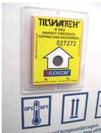
Der selbstklebende **TiltWatch-Indikator** wird durch das Abziehen der rückseitigen Trennfolie aktiviert und danach senkrecht (mit nach oben zeigendem Pfeil) auf das Versandgut geklebt. Wird das so ausgestattete Versandgut während des Transportes gekippt, so verfärbt sich das Indikatorfeld rot. Die Indikatoren sind mit einer Seriennummer ausgestattet, die in den Transportpapieren vermerkt wird und dadurch den unbemerkten Austausch des Indikators verhindert
